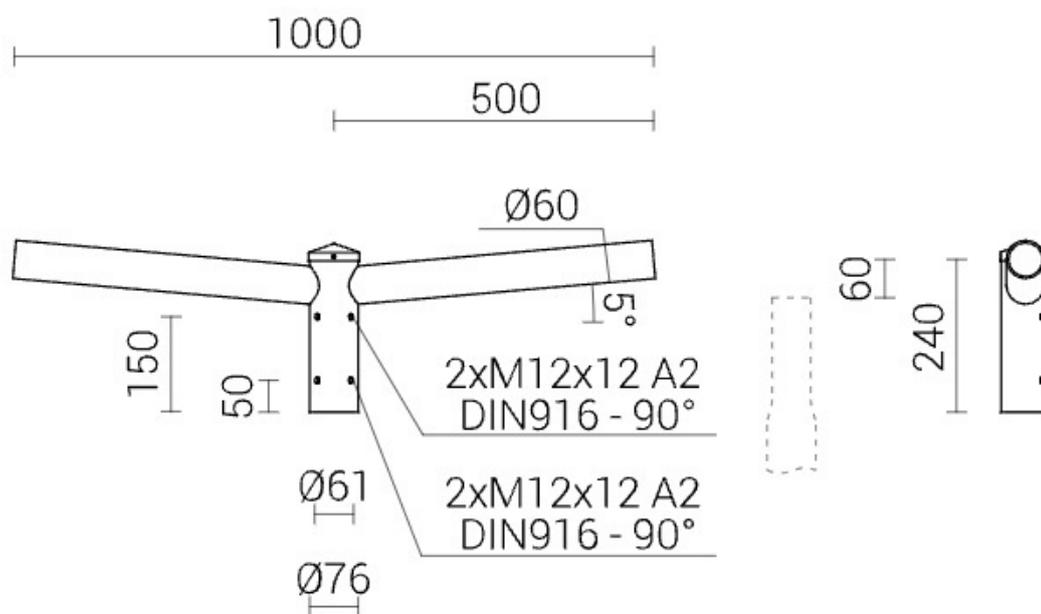
Anodisation 10 couleurs. Garniture en fibre de polypropylène. Usage : poteaux en aluminium avec une extrémité de 60 x 180 mm. Application : montage sur poteaux en aluminium de type SAL avec une extrémité de 60 x 180 mm. Finition : aluminium rectifié. Matériau : alliage d'aluminium anodisé. Certification CE : la flèche et le poteau sont un ensemble. Pour les flèches, la déclaration de performance du poteau sur lequel elles sont montées s'applique.
