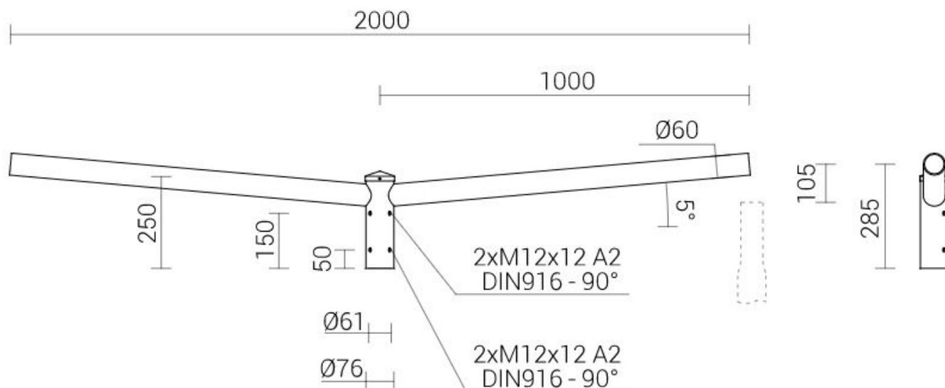
Anodisation 10 couleurs. Garniture en fibre de polypropylène. Usage : poteaux en aluminium avec une extrémité de 60 x 180 mm. Application : montage sur poteaux en aluminium de type SAL avec une extrémité de 60 x 180 mm. Finition : aluminium rectifié. Matériau : alliage d'aluminium anodisé. Certification CE : la flèche et le poteau sont un ensemble. Pour les flèches, la déclaration de performance du poteau sur lequel elles sont montées s'applique.
