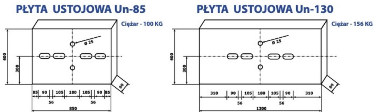
Wykonane z betonu klasy wytrzymałości na ściskanie C 30/37 wg PN-EN-206-1
