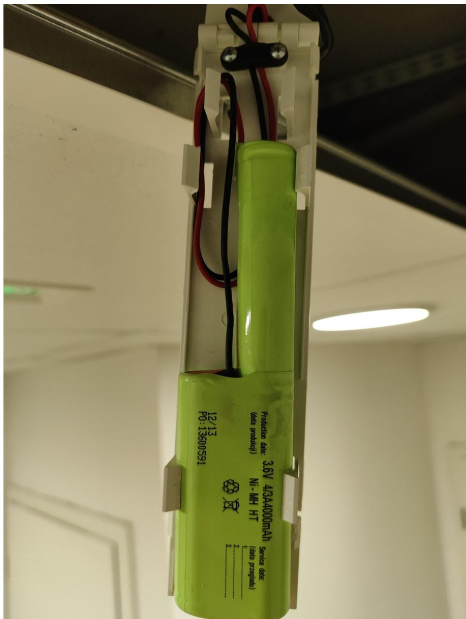
Batteries NiMH (cellules dans un pack 4S)
