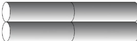
Batteries NiMH (cellules dans un pack 4S)
